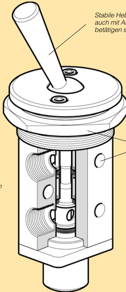
*Die meisten VA13-Ventile können wahlweise als normal geschlossen oder normal geöffnet installiert werden, indem man Anschluß 1 bzw. Anschluß 3 für die Versorgungsluft nutzt.*
